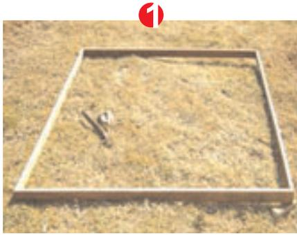
Coroa de madeira com 2 x 2 m e 3 x 2 m, que servirá como gabarito para fixação dos equipamentos.
